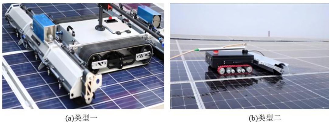
图 1.5 表面移动式光伏清洁机器人
