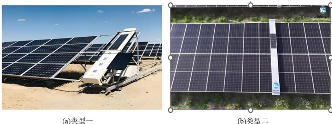
图 1.6 挂轨式光伏清洁机器人
