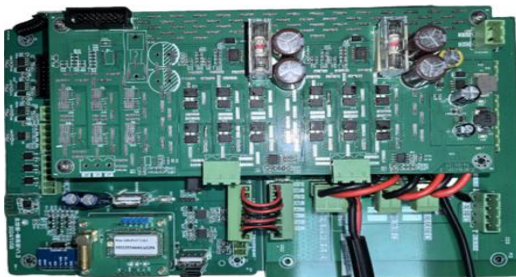
图 2.10 光伏清洁机器人主控板
