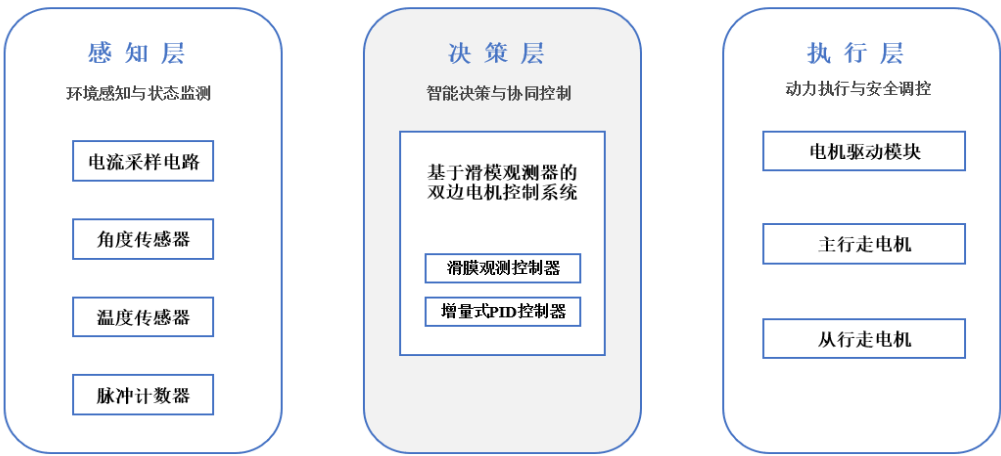
图 3.6 双边电驱智能控制系统架构图
