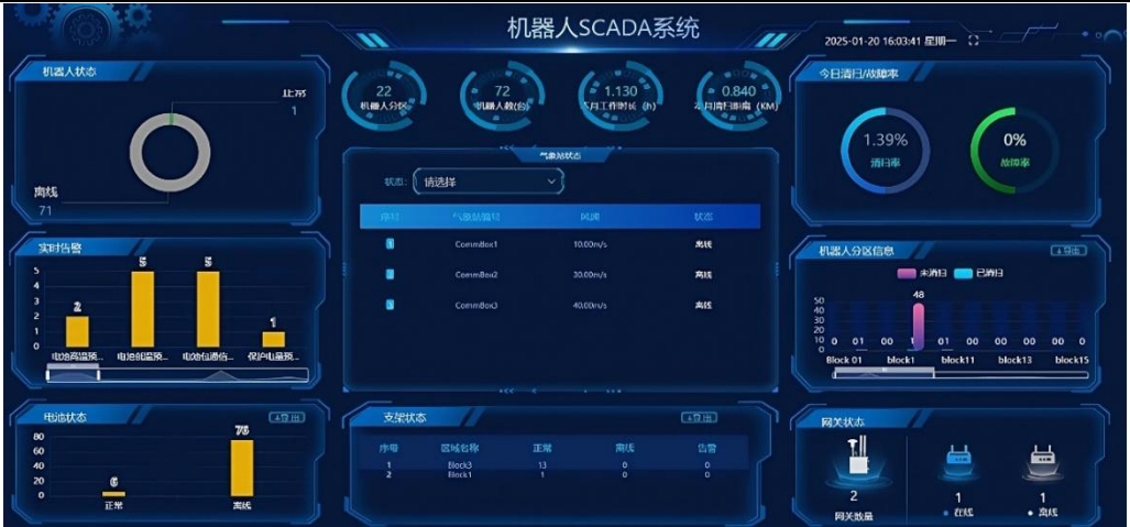
图 2.13 机器人 SCADA 系统主界面
