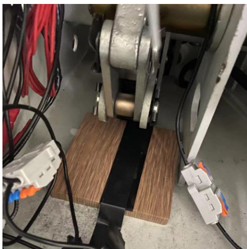
图 4.9 主轴转动卡涩故障模拟
