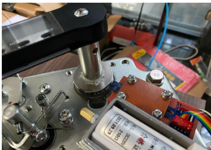
图 3.23 角度传感器安装方案实物图
