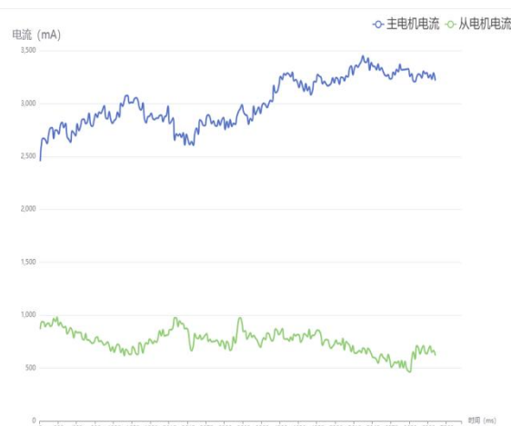
图 3.7 从电机滞后时主电机和从电机电流
