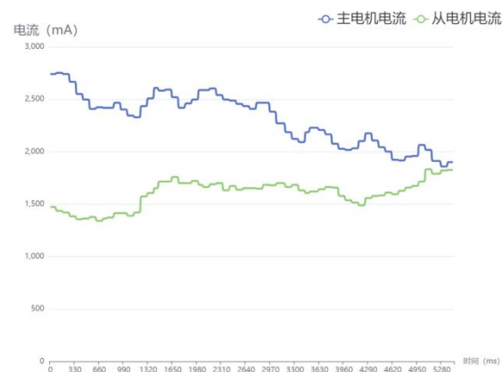
图 3.5 从电机超前时主电机和从电机电流
