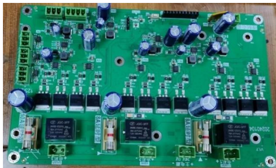
图 2.16 光伏清洁机器人电路板
