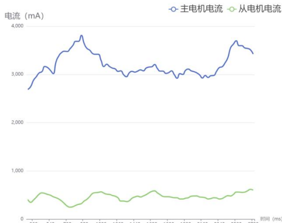
图 3.12 从电机滞后调速时主电机和从电机电流
