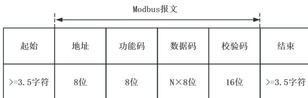
图 2.2 Modbus RTU 格式下的帧结构
