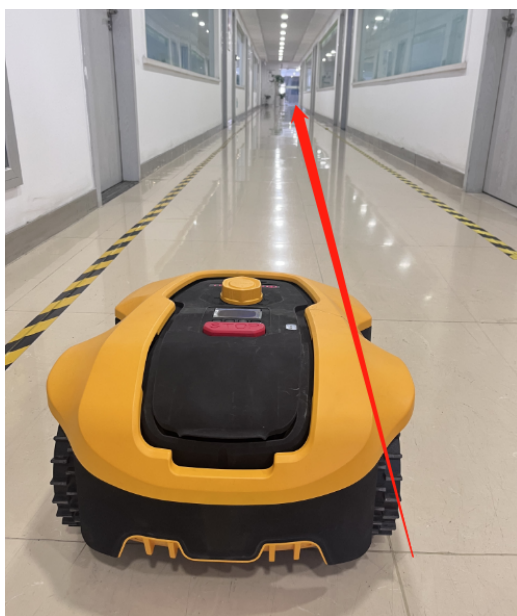
图 4.8 智能割草机平地直线行走测试
