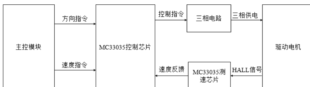
图 2.7 驱动模块电路示意图
