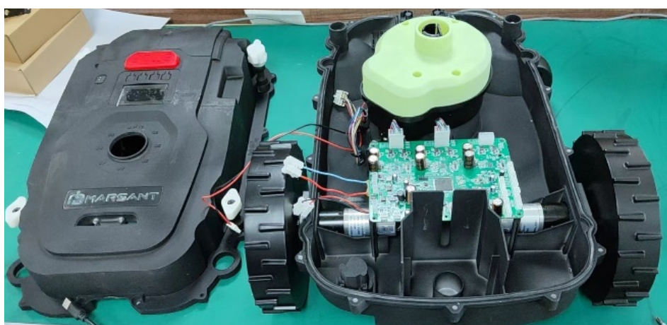
图 3.8 割草机主板安装
