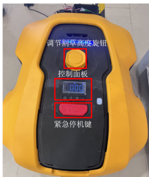
图 2.3 智能割草机正面结构图
