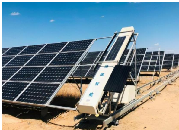
图 1.4 跨排式光伏清洁机器人
