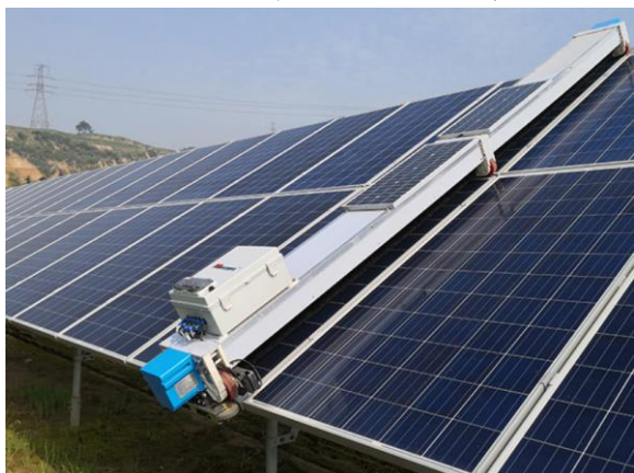
图 1.3 单排式光伏清洁机器人
