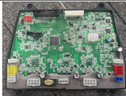
图 2.27 智能割草机主控模块电路板
