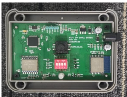
图 2.28 智能割草机无线通信模块电路板
