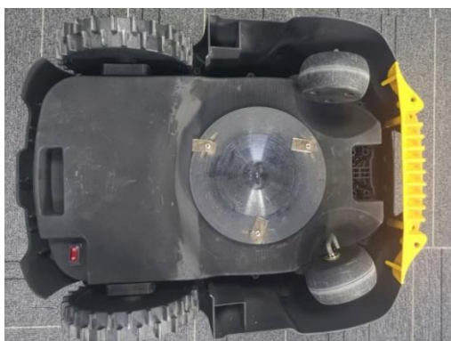
图 2.24 智能割草机底部结构图
