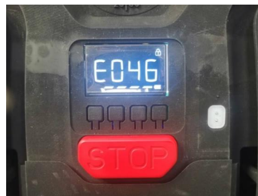
图 2.25 智能割草机按键和 LCD 显示屏
