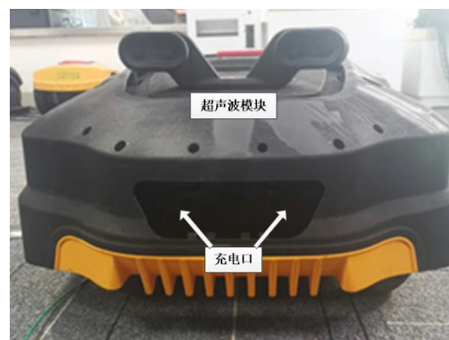
图 2.23 智能割草机正面结构图
