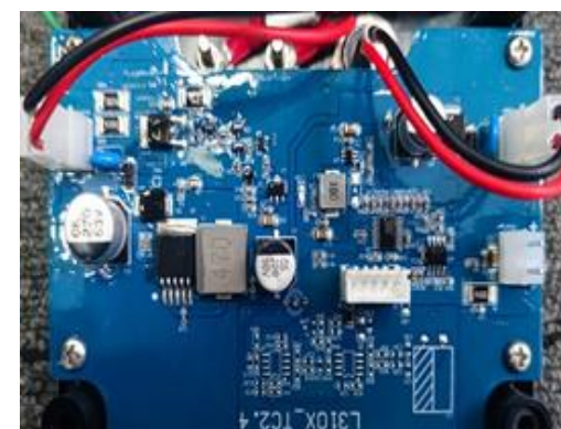
图 2.29 智能割草机充电站电路板
