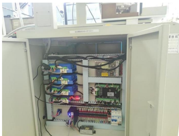
图 2.42 添加电流互感器和气缸接近开关后的自动螺丝机实物图
