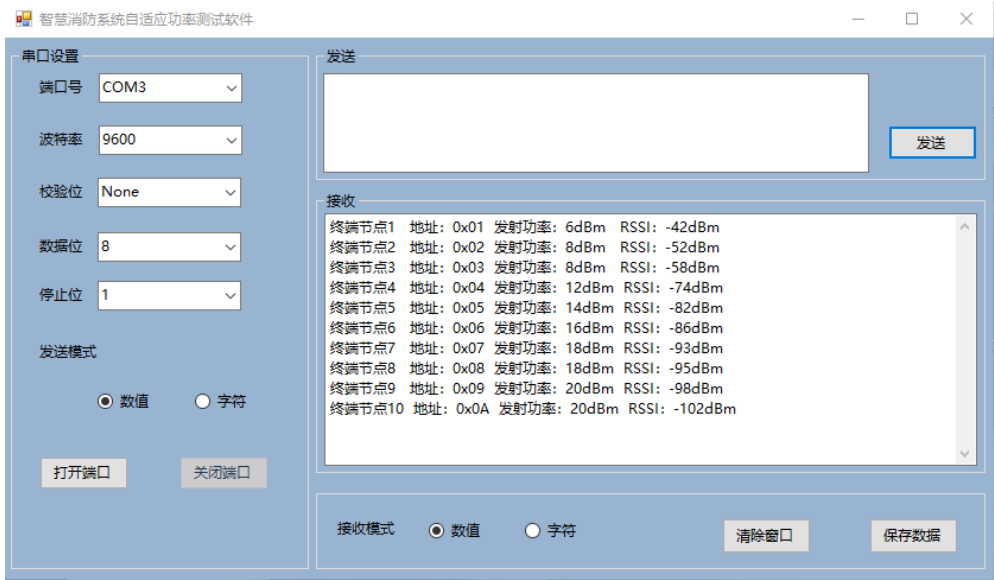
图 3.6 自适应发射功率控制算法测试结果
