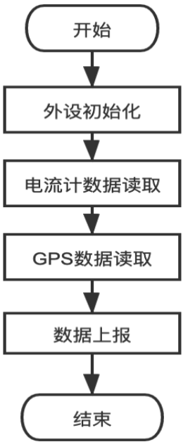
图 2.8 主控软件设计流程图
