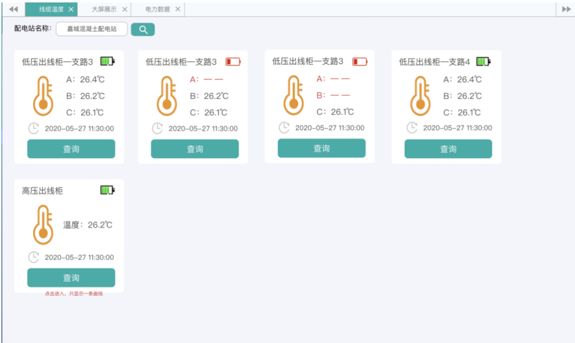
图 2.32 线缆温度监测界面
