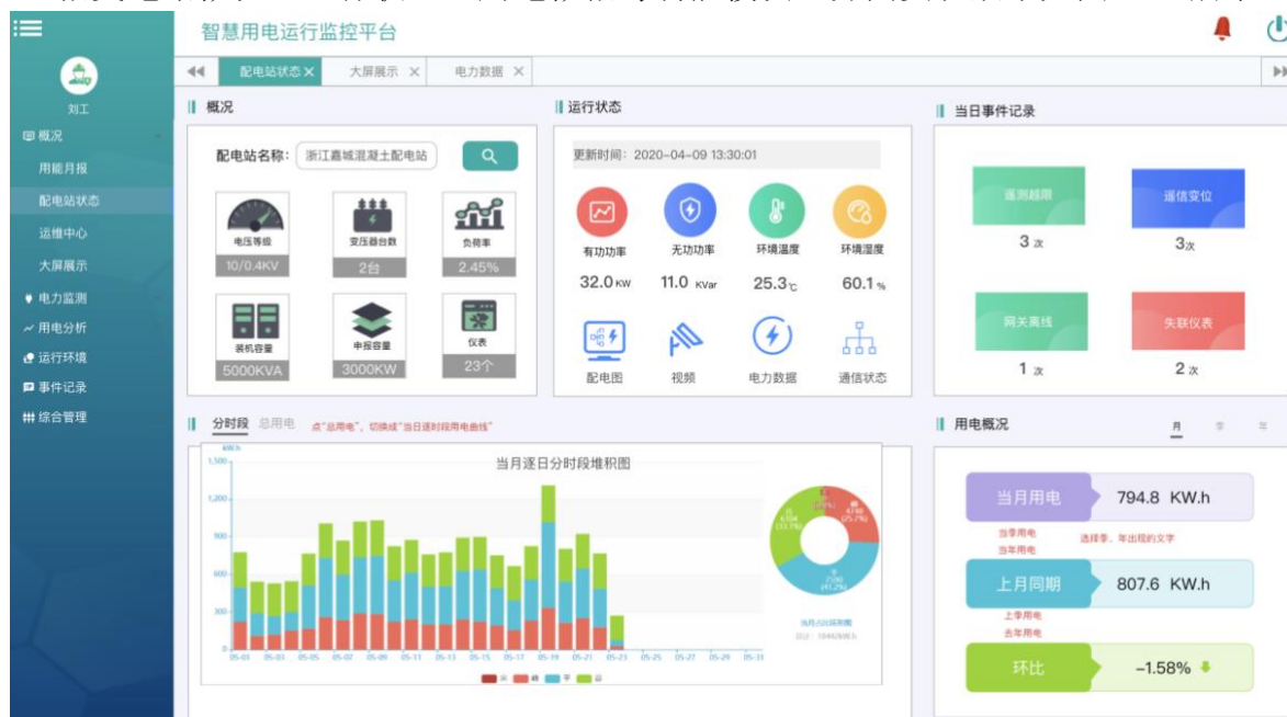
图 2.30 变电站状态界面
