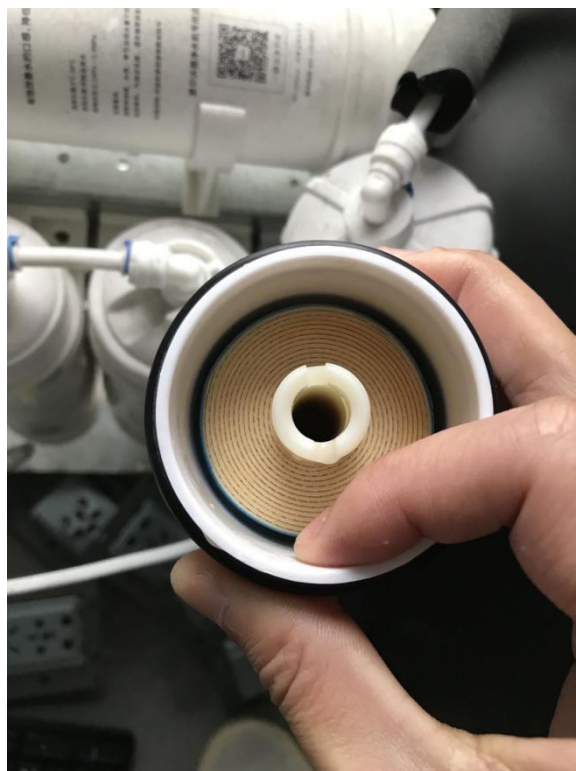
图 1.2 滤芯长期使用被泥沙覆盖变色
